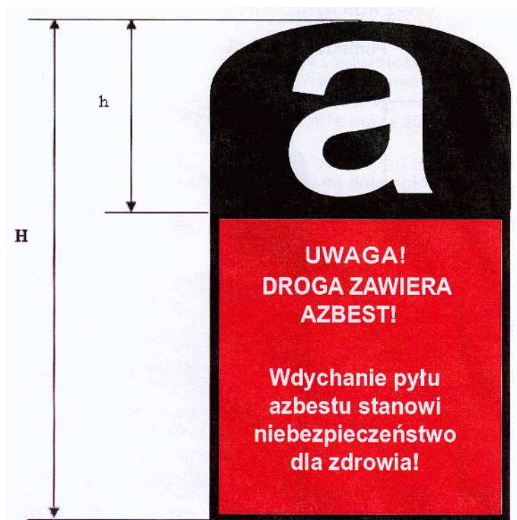
Rycina 15. Wzór oznakowania dróg utwardzonych odpadami zawierającymi azbest przed wejściem w życie ustawy z dnia 19 czerwca 1997 r. o zakazie stosowania wyrobów zawierających azbest, ale niezabezpieczonych trwale przed emisją włókien azbestu
