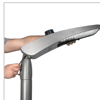
Kąt nachylenia można regulować na miejscu zarówno dla konfiguracji przy montażu bezpośrednio na słupie (0 do +15°) jak i bocznego (0 do -15°).
